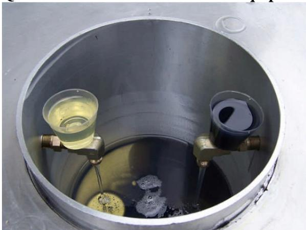
Nous utilisons une unité de démonstration G2F qui permet de contaminer sévèrement l'huile avec de la suie/carbone comme dans la partie droite du réservoir. Nous simulons une contamination extrême puis faisons circuler cette huile à travers la cartouche G2F pour démontrer sa capacité à purifier parfaitement cette huile contaminée. Cette démonstration est faite devant les clients et l'adage «le voir pour le croire » s'applique tout à fait dans ce cas.
