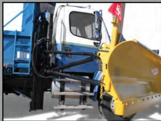
Étant le concepteur de l'accouplement rapide, **Côté** est le seul à avoir pensé à fabriquer une colonne coupe bordure à accouplement rapide hydraulique. Livrable en option, cette colonne coupe bordure vous permettra de rendre votre véhicule encore plus polyvalent, même quand viendra le temps d'abaisser vos remparts.
