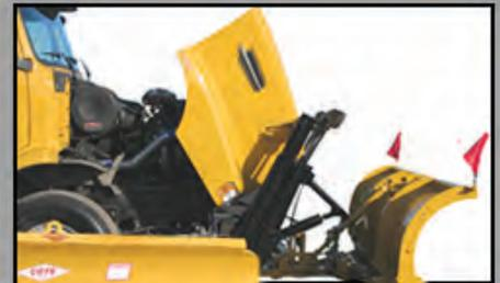
Un véhicule ainsi équipé peut passer de véhicule de déneigement et retourner par la suite rapidement à sa fonction routinière. L'accouplement et le désaccouplement du harnais avant et des bras de poussée s'effectuent en quelques minutes. L'opération s'effectue simplement, rapidement, et ce de façon très sécuritaire.
