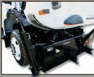
Munie d'attache rapide manuelle sur l'aile de côté en équipement de série, le **HM450** est le harnais de choix pour les camions poids moyen.
