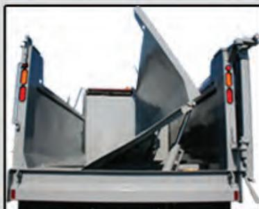
Le plancher & les côtés sont fabriqués en **HARDOX 450**, le protège cabine aérodynamique avec sa poignée d'embarquement intégrée, le support de gyrophare, l'ajustement des chaînes par vérins à graisse, tourniquet d'uréthane à grande dispersion ainsi que le système d'éclairage à **DEL** sont de série.
