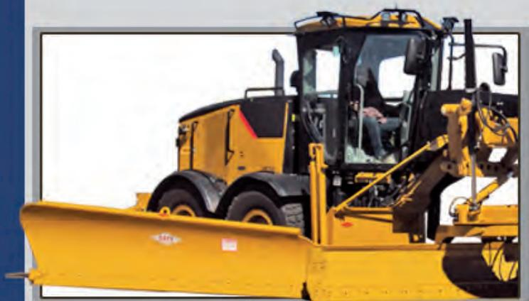
Sa conception de plaques de métal moulé monocoque offre une rigidité supérieure à la torsion et épouse esthétiquement les formes de la machine à laquelle il est adapté. Disponible en attache rapide ou manuel, le **H700** est donc un choix économique et polyvalent.
