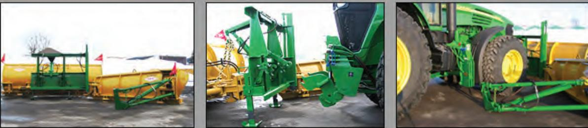
La série **AR9000** est un harnais à accouplement rapide pour chasse-neige avant avec aile de côté ou souffleuse. Il s'adapte aux séries 7720 / 7820 / 7920. En moins de 15 minutes il vous permet d'interchanger les 2 équipements.
