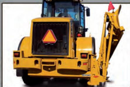
Le harnais **H700** est adapté à la partie arrière soit d'une chargeuse sur pneus ou d'une niveleuse.
