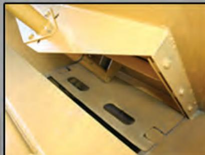
Compromis parfait entre l'épandeur traditionnel et la benne quatre saisons, la **BEU900** offre une conception d'avant-garde avec sa structure de type monocoque à ailes moulées. Le plancher & les côtés sont fabriqués en **HARDOX 450**, le protège cabine aérodynamique avec sa poignée d'embarquement intégrée, le support de gyrophare, tourniquet d'uréthane à grande dispersion, le système d'éclairage à **DEL** ainsi que l'ajustement des chaînes par vérins à graisse sont de série.
