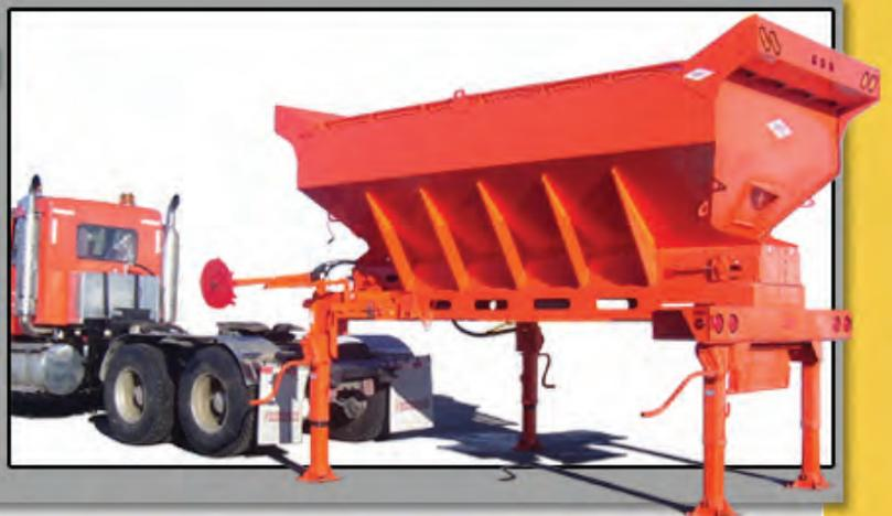
Elle peut être glissée directement dans la benne existante de votre camion, installé sur le châssis muni d'ailes ou bien encore, fixé avec notre populaire système d'attachement rapide unique à **Côté**, celui-ci s'adapte à la cinquième roue (fifth wheel) de votre camion tracteur.
