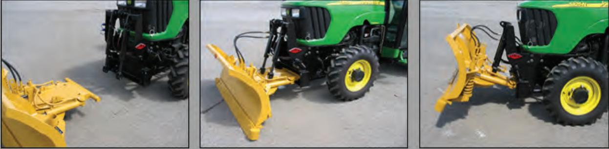
La série **KL6000** est conçue spécialement pour le déneigement des trottoirs, s'adaptant sur les tracteurs de séries 5010N/20N, 5310N/20N/25N & 5510N/20N/25N. Cette série est disponible dans les largeurs de 5, 6, 7 et 8 pieds. Un axe de pivotement horizontal, est offert en option, il permet d'ajuster l'angle du chasse-neige à la surface du trottoir.
